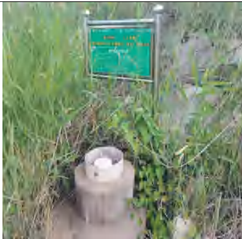
地下水监测井 1
