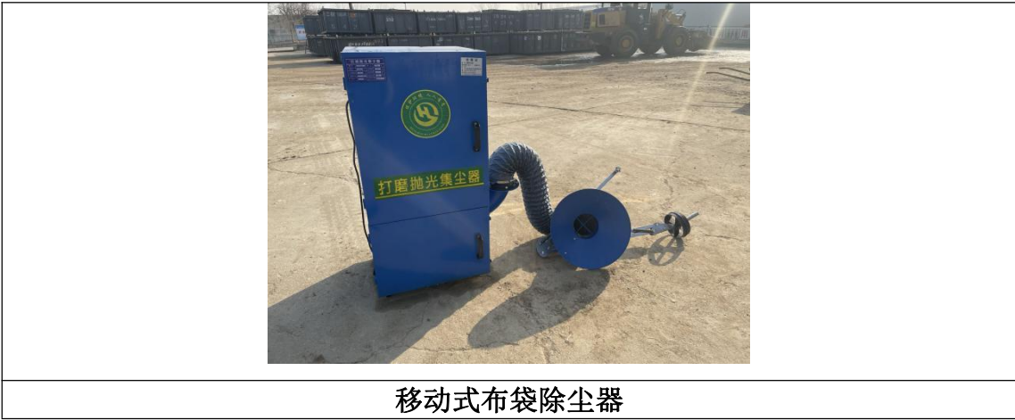
图 4-1 废气治理设施
